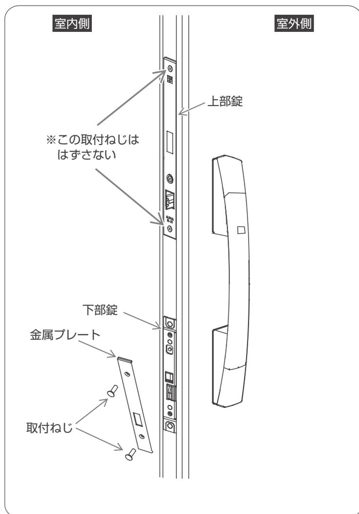
① プラスドライバーで下部錠の金属プレートの取付ねじをはずし、金属プレートをはずす。
