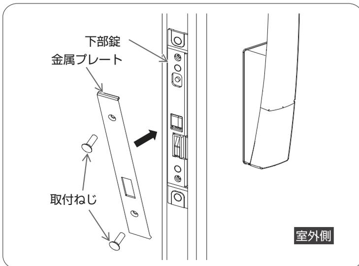
① 下部錠の金属プレートを下部錠に合わせ、プラスドライバーで取付ねじをしめる。
