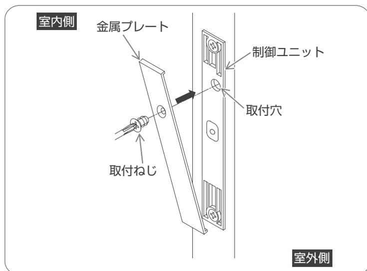
① 金属プレートを制御ユニットの取付穴に合わせ、プラスドライバーで取付ねじをしめる。
