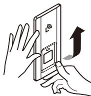
化粧プレートが落ちないように支えてください。そのまま図の通りに下から押し上げ、上へスライドさせてください。
